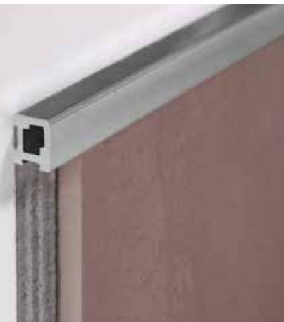
Squarejolly SJQ ist eine patentierte dekorleiste aus Aluminium für Fliesenwandbeläge. Der symmetrische viereckige Querschnitt bietet eine patentierte Vielfalt von Verlegungslösungen auch mit modernen Fliesengrößen. Das Profil, dank dem Querschnitt mit zwei Schwalbenschwänzen, bietet eine perfekte mechanische Verankerung und ist als ästhetische Lösung in Holzarbeiten nach der Verlegung oder als Dekorleiste geeignet.
